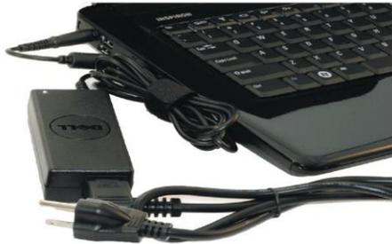
وحدة النظام، وتقوم بالتحويل AC to DC ، وتزود الطاقة لمكونات وحدة النظام، ويمكنها إعادة شحن البطاريات . هذه
