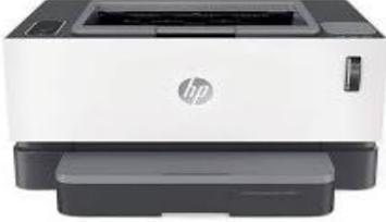
8. طابعات الليزر ( Laser ) : تعمل بنفس طريقة عمل ماكينات التصوير وتستخدم الليزر لرفع شحنة كهربائية على شكل النص أو الصورة لتطبع على أسطوانة، والمنطقة المشحونة من الأسطوانة ت جذب مسحوق أسود (Toner) إليها والمسحوق يضغط على الورق كلما دارت الأسطوانة، ثم تسخن الورقة لطبع الشكل على الورقة، وهذه
